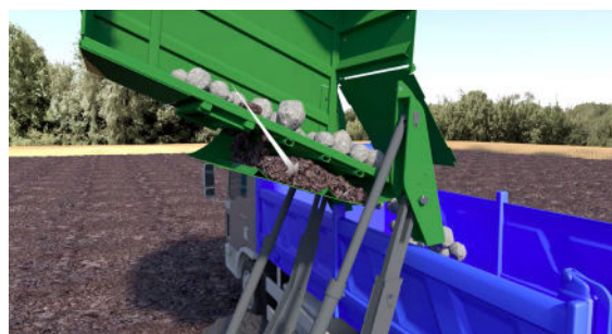
3. Overskydende jord glider ned i en separat beholder, som er placeret bag stentankens bagvæg og frigives i tippetfasen.
