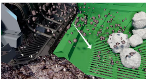
2. Stenene transporteres til tanken, og jorden i sigtestrukturen falder tilbage på marken.
